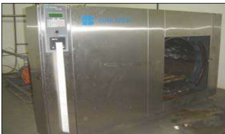
Figura 3.40 – Autoclave para os resíduos sólidos de saúde
