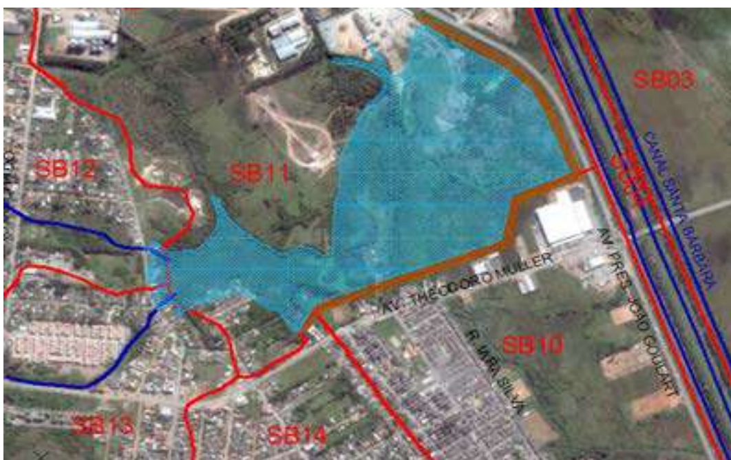
Figura 40: Proposição 2 - Reservatório na cota de coroamento 5,0 m.
